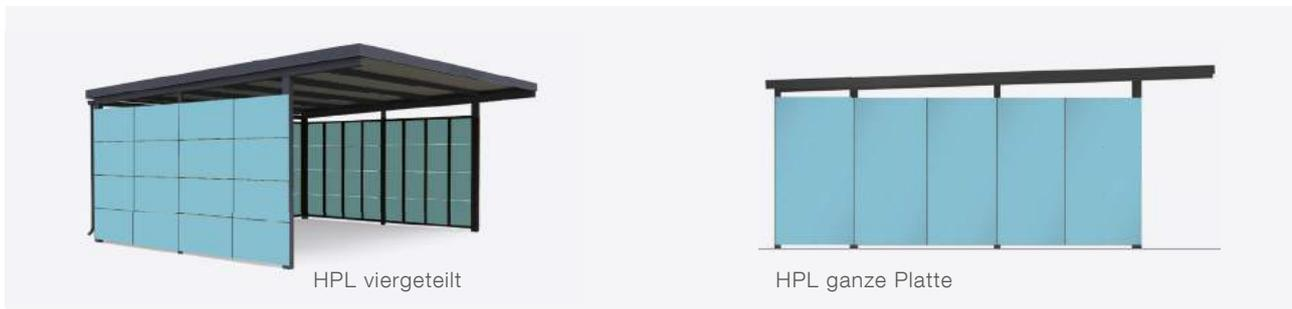
Der Gerhardt Braun Carport mit HPL Seitenwandverkleidung kann wahlweise mit einer horizontalen Vierteilung der HPL-Platten ausgeführt werden oder mit ganzen Platten je Feld. Sie können aus mehreren Farbpaletten den geeigneten Farbton wählen. Die Platten werden mit farblich passenden Blindnieten sicher und dauerhaft auf unserer Stahlkonstruktion befestigt. Bei unseren HPL-Standardfarbtönen können wir Ihnen verkürzte Lieferzeiten anbieten.
