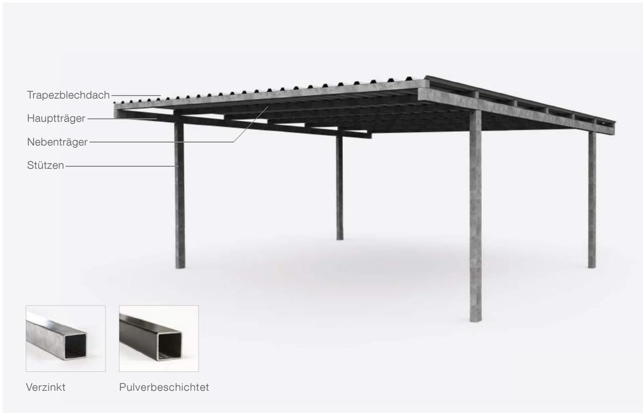
Feuerverzinkte Stützen mit Fußplatten werden auf bauseitigen Fundamenten montiert. Die Hauptträger verlaufen in Fahrtrichtung und nehmen die Dachlasten aus den Nebenträgern auf. Das schlanke Trapezblech wird auf den Nebenträgern befestigt.
